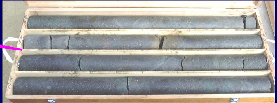
亀裂に粘土を挟む岩盤
